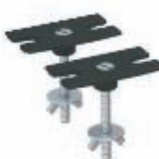
Комплект для фиксированного крепления настольного бокса DB на поверхности стола. Монтаж выполняется через отверстие (Ø 10 мм) в столешнице. Крепежные болты M4 x 40 мм применяются для столешниц толщиной не более 32 мм.
