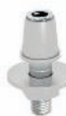
Крепежная опора из нержавеющей стали для фиксированного монтажа настольного бокса DB на поверхности стола. Монтаж выполняется через отверстие (Ø 16 мм) в столешнице. Применяется для фиксации на столешнице толщиной не более 50 мм.
